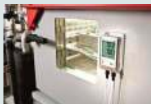
testo 176 T4: înregistrarea temperaturilor în camere climatice prin patru canale.
