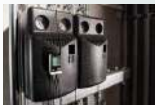
testo 175 T3: înregistrarea temperaturilor pe tur și retur în instalațiile de încălzire.
