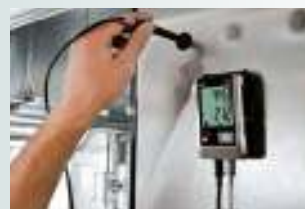
testo 176 H1: înregistrarea temperaturii și umidității în instalațiile de ventilație și climatizare.
